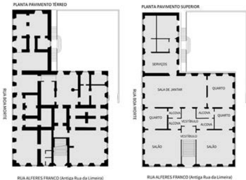
Figura 12 – Plantas da casa senhorial urbana de Sebastião Barros. Reconstituição – do programa original. Fonte: elaborada pelas autoras a partir do Projeto de restauração Palacete Levy. Memorial de restauro (2005), de Juliana B. P. Scariato. Anexo n. 10 e 11, Planta térreo e pavimento superior.
