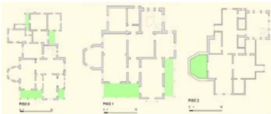
Figura 8 – Planta baixa do palacete com delimitação em verde de todas as varandas e solaria existentes. Fonte: Pietra P. Barreto, 2019.
